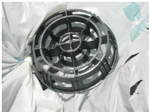
Figura 4.- Desno: Podloge za podršku korišćene u SAF procesima koji se koriste (prosečni prečnik: 12-15 cm). Leva SAF jedinica ispunjena sirovim materijalima tipa Pall-prstenovi (prosečni prečnik 9 cm).
