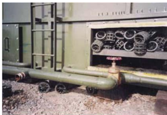
Figura 4.- Desno: Podloge za podršku korišćene u SAF procesima koji se koriste (prosečni prečnik: 12-15 cm). Leva SAF jedinica ispunjena sirovim materijalima tipa Pall-prstenovi (prosečni prečnik 9 cm).
